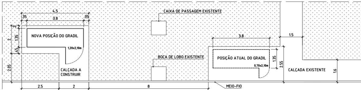
CROQUI ILUSTRATIVO DA NOVA LOCALIZAÇÃO DO DEPÓSITO DE BOTTIÕES DA GERÊNCIA DE MATERIAL ESCALA 1:100
